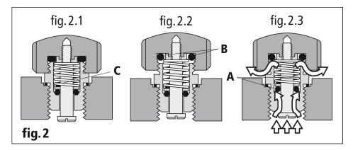
Na fase de descompressão, desaparafusar a coroa da válvula para activar o seu mecanismo (fig. 2.2). Então, ela é estanque no sentido exterior-interior. Quando a pressão interior é mais forte do que a pressão exterior, comprime a junta (A) para fora da sua base libertando o gás (fig. 2.3). Com as duas pressões equilibradas, a junta (A) retorna ao seu lugar, premida pela mola (C) (fig. 2.2).
